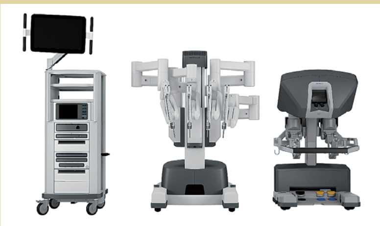
左からビジョンカート・パイセントカート・サージョンコンソールとダヴィンチの頭脳及び目の役割・ロボットアーム・操縦席になります
